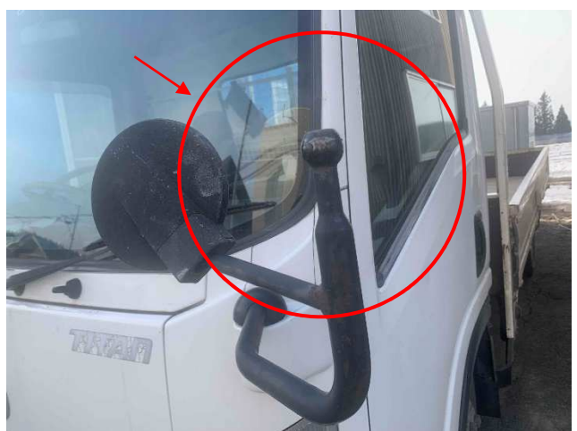
トラックの破損箇所 (左バックミラー及びフロントガラス)
