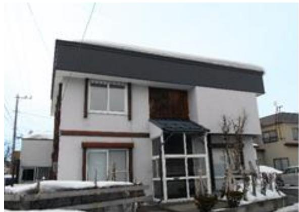
図 69 住宅（無落雪屋根への改修後）
